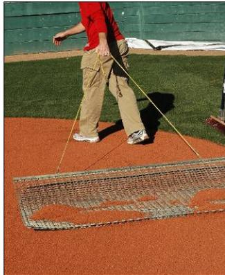
Una explanadora se usa para alisar las áreas sin césped del cuadro interior. Hay varios modelos de explanadoras disponibles. Una explanadora se puede jalar con la mano o sujetarse a la parte trasera de un vehículo. Algunos vehículos motorizados de mantenimiento vienen equipados con implementos para explanadoras. Las explanadoras se construyen con una malla de acero. Algunas explanadoras se usan para terminar el campo. Se hacen de tapetes "cocoa". Esta fibra natural asegura una apariencia lisa.
