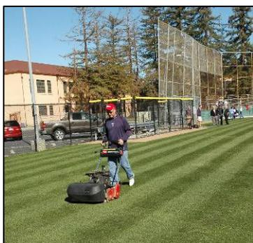
Hay dos tipos de cortacéspedes disponibles para cortar el campo: 1) rotatorio, y 2) cortacéspedes con bobina. El tipo más común de cortacésped es un cortacésped rotatorio. Los cortacéspedes rotatorios se usan principalmente en los céspedes residenciales.
